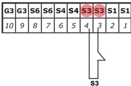
**Connections for diagram 0 and DHW Kit**
